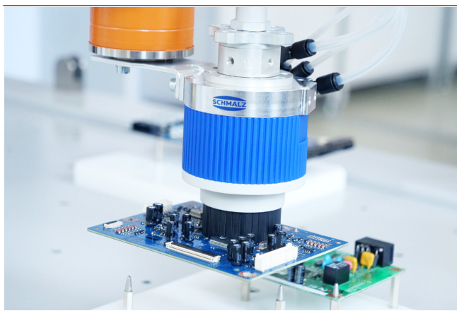
Strömungsgreifer SCG-HSS bei der Handhabung von bestückten Leiterplatten
